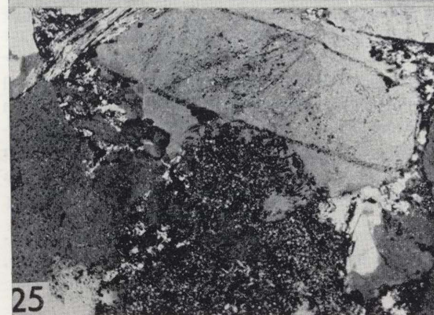
Figura 22.—Canto blando deformado y algo recrystalizado, arcilla alogénica en una subarcosa. NP. \times 50 .
