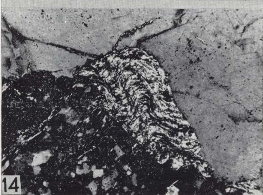
Figura 12.—Cuarzos monocristalinos. Se observan crecimientos secundarios enfatizados por películas de óxidos de Fe. NC. \times 50 .
